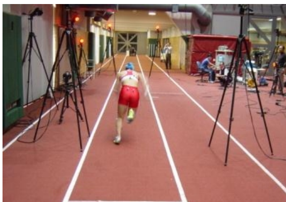
短距離走の動作解析実験
